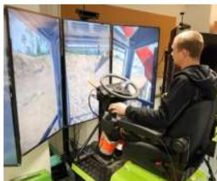
*Stagiaire utilisant un simulateur de manutention*
