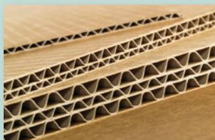
Le carton ondulé est composé de deux feuilles de papier appelées **couvertures** entre lesquelles est collé un papier ondulé appelé **cannelure**. Ces différentes couches (de 2 à 5) une fois assemblées donne à la structure générale une résistance bien supérieure à celle de chaque couche.
