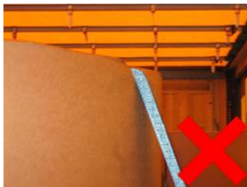
Figure 34 : Exemple d'un bord de bobine endommagé
