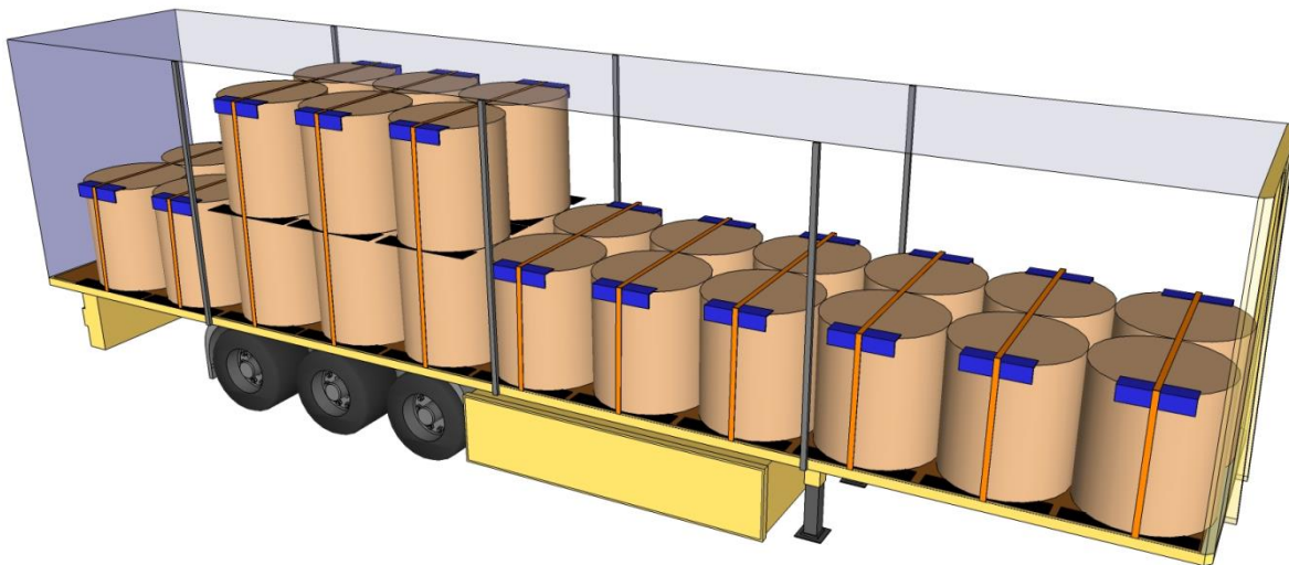
Figure 46 : Arrimage dans un véhicule de type semi-remorque à rideaux avec des sangles et des tapis antidérapants sous les bobines. Les bobines sont arrimées avec 11 sangles couvrantes.
