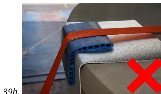
Figure 39 : Cornières non-appropriées : les cornières sans espace interne sont inadaptés pour protéger le bord fragile de la bobine
