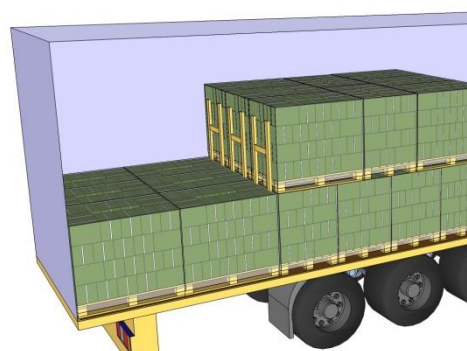
27d : Blocage par panneau/barrière
