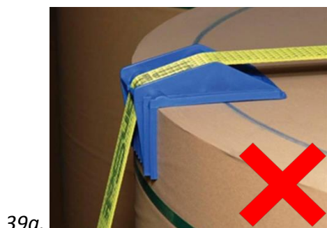
Figure 39 : Cornières non-appropriées : les cornières sans espace interne sont inadaptés pour protéger le bord fragile de la bobine
